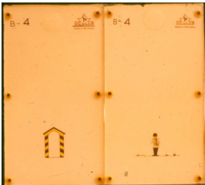
Slika 60. Određivanje objektivnog kuta škiljenja na sinoptoforu pomoću sličica (npr. vojnik i kućica)
